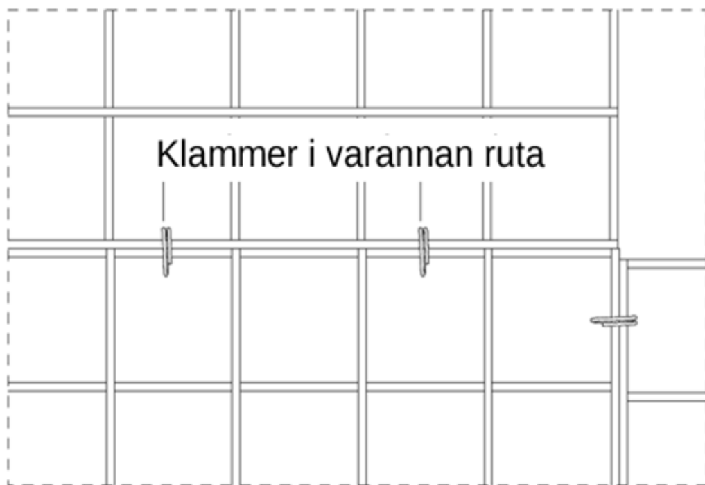
Bild 5 Näten sammankopplas i varandra med klammer (i varannan ruta)
